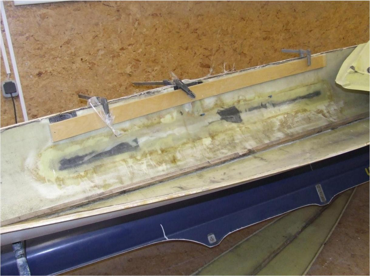
Der Riss wird von innen und außen mit Matten belegt.
