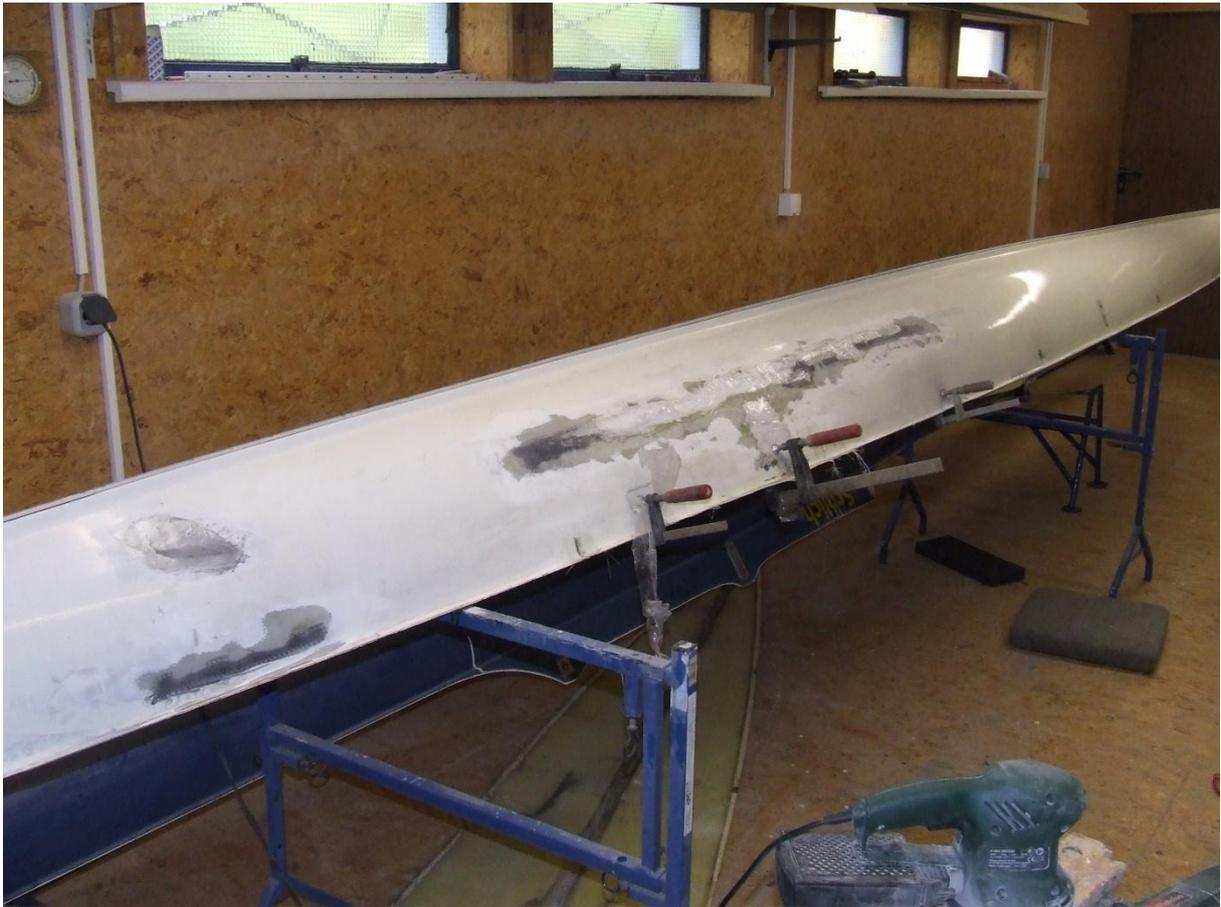
Ein großer Riss im Unterwasserschiff wird langwierig geschlossen.
