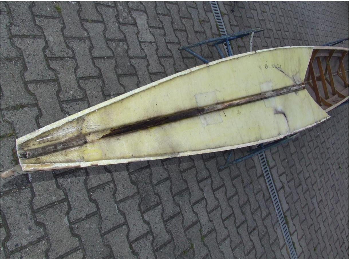
Der Deckel ist gerissen und die Stütze vollständig weggegemelt!
